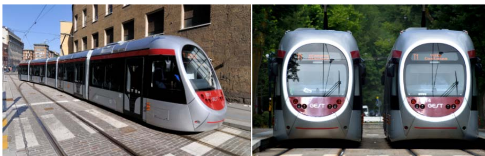
Рис. 1. Модифицированные трамваи Hitachi с аккумуляторной батареей серии Sirio
